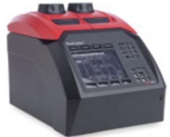
mit Gradientenfunktion erhältlich. Der FlexCycler<sup>2</sup> bietet state-of-the-art Heiz- und Kühlraten und reproduzierbare Bedingungen in allen Positionen der Probenblöcke durch seine exzellente Temperaturuniformität. Durch das bedienungsfreundliche Softwarekonzept in Verbindung mit umfangreichen weiteren Softwareoptionen bildet der FlexCycler<sup>2</sup> das perfekte System für anspruchsvolle PCR-Anwendungen.
