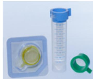
chen – die Filtration erfolgt zügig und ohne Überlaufen. Darüber hinaus kommt EASYstrainer™ ohne seitliches Filtrationsgewebe aus. Diese spezielle Eigenschaft verhindert die Ansammlung von Filtrationsflüssigkeit zwischen Sieb und Röhrchen und die damit verbundene Gefahr eines Flüssigkeitstaus.
