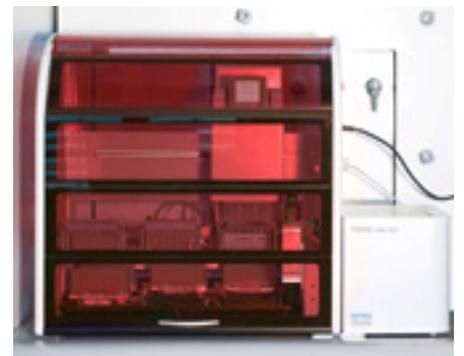
**Abb. 5** FADU Genotox Hardware (von CETICS Healthcare Technologies GmbH).
