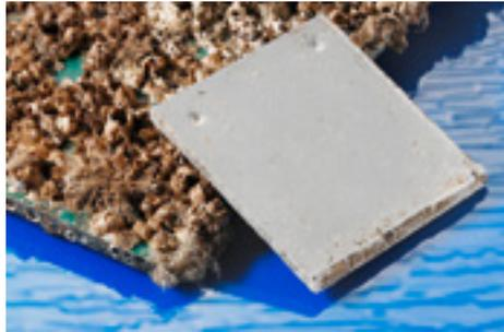
Beispiel für einen biozidfreien Bewuchsschutz nach erfolgter Reinigung im Vergleich zur nicht geschützten Probe. *Bild: Fraunhofer IFAM*
