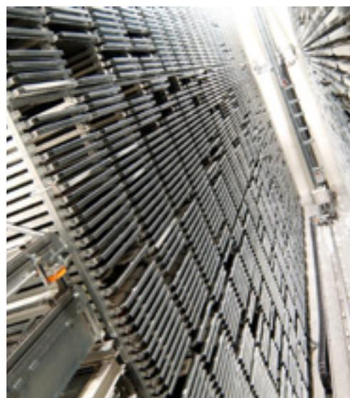
Das FPQ (Frischplasma-Quarantäne)-Lager am Standort Wiesentheid dient unter anderem der Lagerung der Nachuntersuchungsproben bei minus 42°C und ist eines der weltgrößten voll automatisierten Probenlager.
