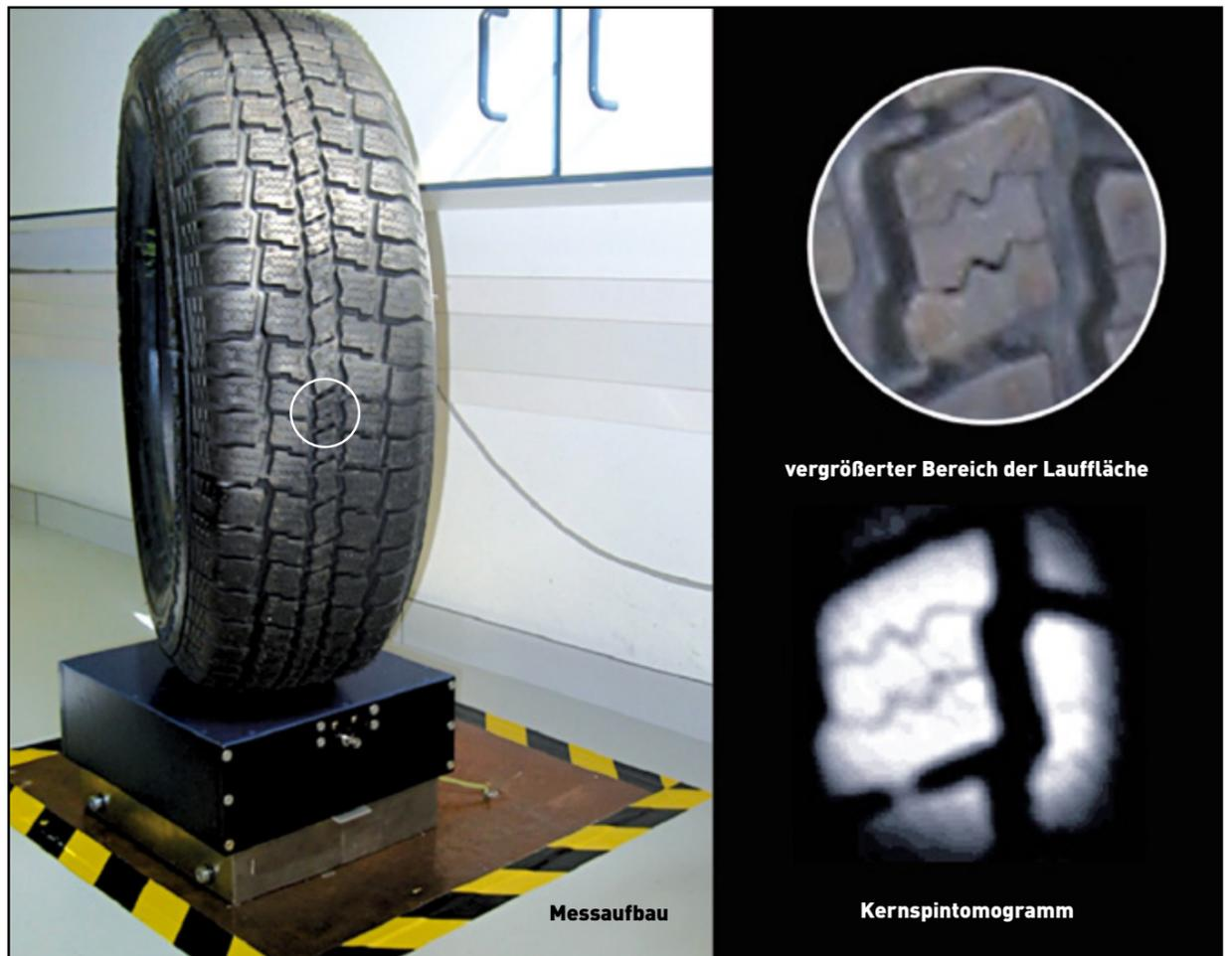
Abb. 1 Messung eines Kernspintomogramms aus der Lauffläche eines PKW-Reifens.
