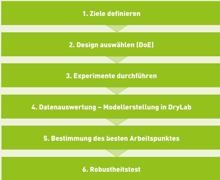
**Abb. 1** Flussdiagramm zur Vorgehensweise bei der HPLC-Methodenentwicklung nach den Prinzipien von Quality by Design (QbD).
