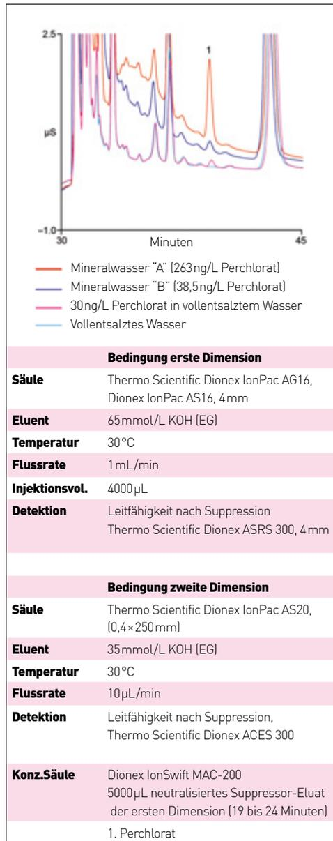
Abb. 3 Perchloratbestimmung in Mineralwasser mit 2D-IC und einer Kapillarsäule in der zweiten Dimension
