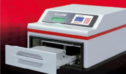
Das InfraSORP Messgerät charakterisiert die Adsorptionseigenschaften von 12 Proben in wenigen Minuten.
