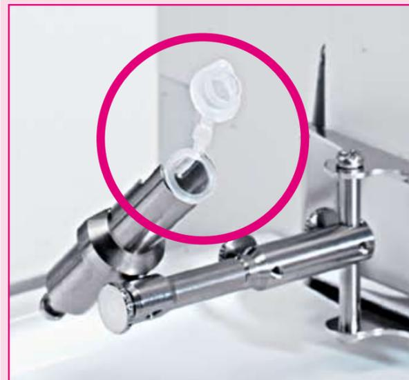
**ErgoClip Tube** die sicherste Lösung für das Befüllen von Tubes (z.B. Eppendorf- oder PCR-Tubes).
