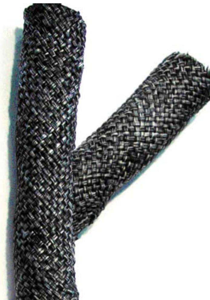
Faserstruktur eines verzweigten technischen Faserverbundes
