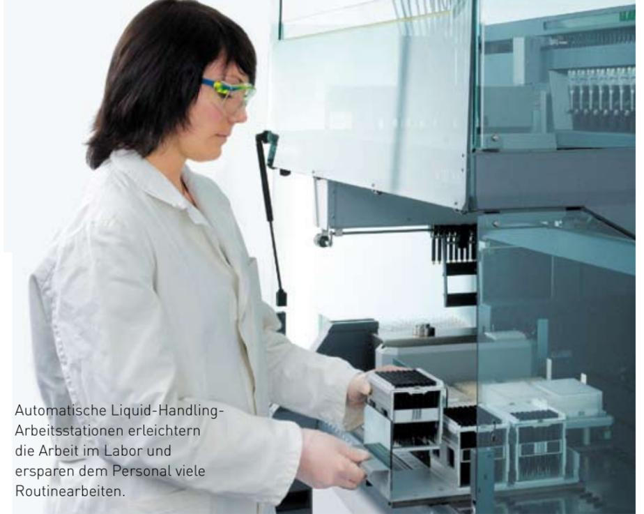
Automatische Liquid-Handling-Arbeitsstationen erleichtern die Arbeit im Labor und ersparen dem Personal viele Routinearbeiten.
