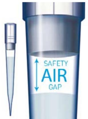
Natürlich entsprechen die Filter-Spitzen von Biohit den Anforderungen DNase-, RNase- und endotoxinfrei. Sie sind gefertigt aus umweltfreundlichem Polypropylen und passen neben den Biohit-Pipetten auf die Pipetten anderer namhafter Hersteller. Das Volumen der Spitzen variiert zwischen 10 und 1200 µl. Die Spitzen sind steril verpackt in farbkodierten Boxen.
