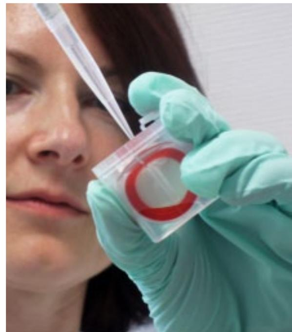
**Abb. 1 Manuelle Befüllung eines Bioreaktors für die zellfreie Proteinsynthese im Millilitermaßstab**
