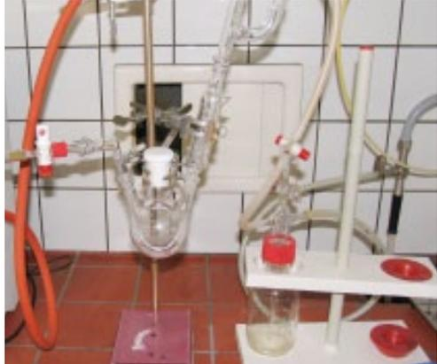
**Abb. 1** Aufbau der verwendeten Rauchapparatur für die Simulation des Rauchverhaltens eines Drogenkonsumenten. Die Apparatur besteht aus einer Glasfrittensäule [links], einem Adapter, einem Vakuumvorstoß, einem 250ml-Dreihalsrundkolben mit einer Vigreux-Kolonne [oder wahlweise mit einem Liebig-Kühler], einem Zweihalsaufsatz, zwei Übergangsstücken mit Olive, einer 500ml-Waschflasche, einer Wasserstrahlpumpe und einer Vakuumanzeige.
