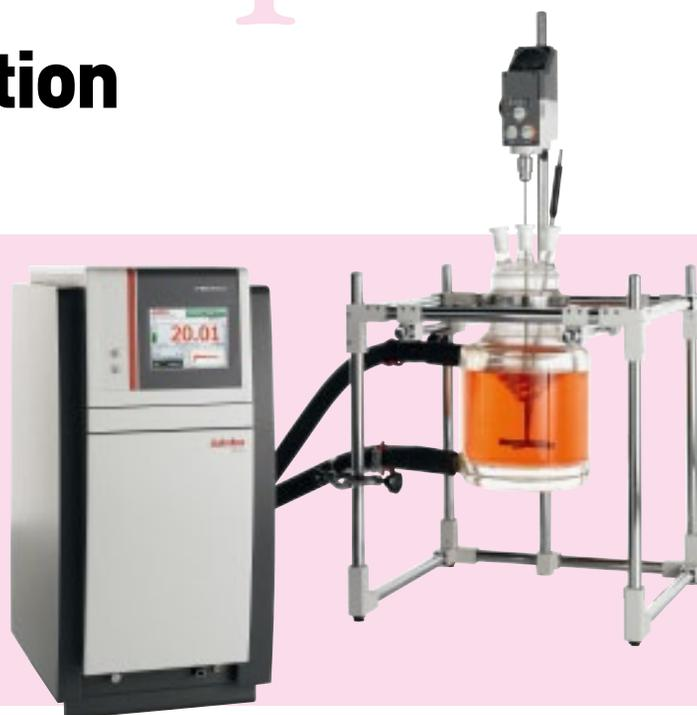
Mit den neuen PRESTO® bietet JULABO Spitzen-Technologie für moderne Labors an. Zur hochpräzisen Regelung von Temperaturen und zur Kompensation schneller Temperaturwechsel bieten die neuen PRESTO® 2,7kW Heizleistung. Die neuen PRESTO® sind äußerst robust und arbeiten selbst bei erhöhten Raumtemperaturen bis  $+40^{\circ}\text{C}$  zuverlässig. Die integrierte Kältemaschine und das interne, gekühlte Expansionsgefäß fangen Volumenänderungen im Wärmetauscher permanent auf.
