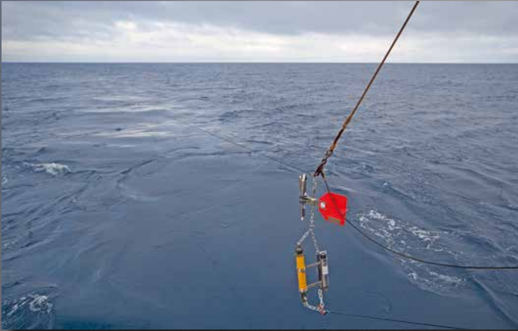
Ein vertikal profilierender Argo-Float wird im Südozean ausgesetzt (Foto: Alfred-Wegener-Institut / Frank Rödel).
