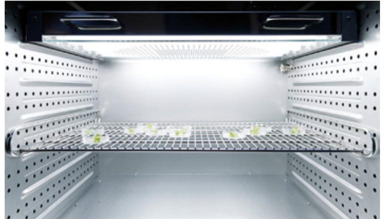
Das Beleuchtungssystem spielt bei den Binder Lichtschränken für die Kultivierung von Pflanzen sowie für Photostabilitätstests gemäß ICH-Richtlinie eine zentrale Rolle. Eigens für diese Anwendungen wurde eine Lichtkassette mit besonderen Eigenschaften entwickelt. Die patentierte Beleuchtungseinheit besteht aus einem Edelstahlgehäuse mit fünf energieeffizienten Leuchtstoffröhren, einem rückseitigen Reflektor und einer frontseitigen Blendscheibe. Insbesondere diese teilreflektierende
