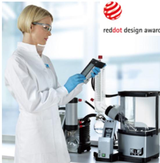
und einfache Reinigung – im Labor eine wichtige Eigenschaft. Das Design hat auch eine wichtige Sicherheitslücke geschlossen: Alle Schläuche sind sicher im Kolbenturm verwahrt, selbst das Heizbad kommt ohne Kabelverbindungen aus. Der RC 900 lässt sich mit dem SC 920 Vakuumpumpensystem und dem C 900 Kühler unkompliziert zu einem wirtschaftlich arbeitenden Komplettsystem erweitern.
