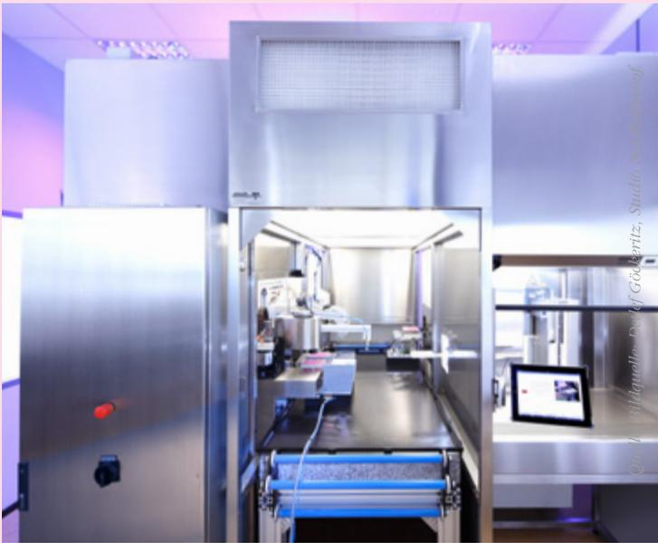
**Abb. 1** Das Autranomics-System steuert Zellkultivierungsprozesse vollkommen selbstständig. Es erfasst und dokumentiert den Zustand der Zellen zu jedem Zeitpunkt des Wachstumsprozesses.
