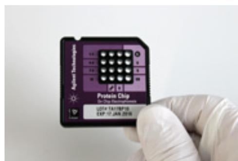
**Abb. 5** Kapillarelektrophorese (Lab-on-Chip mit Offgel®, zweidimensionale Gelelektrophorese), die eine Proteincharakterisierung der Malze ermöglicht
