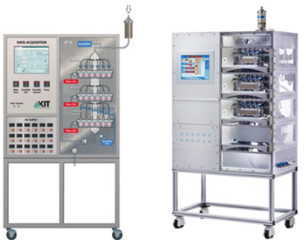
**Abb.2** Automatisiertes Expositionssystem zur reproduzierbaren Exposition von Bioassays an der Gas-Flüssigkeits-Grenzschicht. Links: Schematische Darstellung der verfahrenstechnischen Hauptkomponenten. Rechts: Foto des fertigen Produktes von Vitrocell Systems *Quelle: KIT; Vitrocell Systems GmbH*
