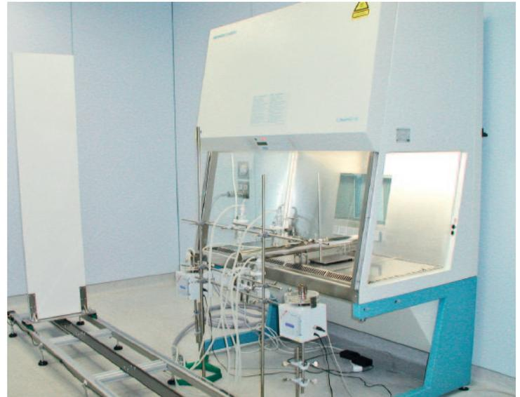
Abb. 1: Prüfstand der mikrobiologischen Prüfung des Personenschutzes gem. DIN EN 12469 mit Störung "bewegter Mensch".
