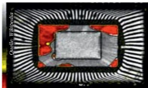
Abb. 2 Akustisches Bild eines integrierten Schaltkreises mit Materialablösung im Inneren (rot)
