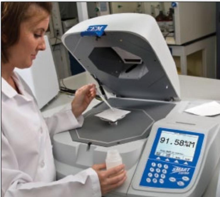
**Feuchteanalyse in nur 2 Minuten.** Für eine exakte Feuchtebestimmung wurde das Mikrowellen-Analysensystem SMART 5 Turbo entwickelt, welches das Mikrowellenfeld gleichmäßig ausbildet und fein zu regeln vermag. Das fokussierte Mikrowellenfeld ist für eine gleichmäßig präzise Aufwärmung des Probengutes von entscheidender Bedeutung. Damit kann das SMART auch für sensible Proben eingesetzt werden.
