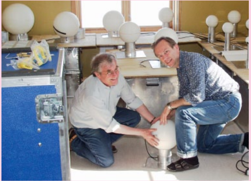
Abb. 3 Aufbau eines Bonner Vielkugelspektrometers auf der Koldewey Station des Alfred Wegener Instituts auf Spitzbergen. Hier misst das Helmholtz Zentrum München ebenfalls sekundäre Neutronen der kosmischen Strahlung.
