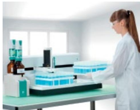
die Titration tiamo™ und ist denkbar einfach. Anwender müssen lediglich die Proben bzw. die Racks auf den Wechsler stellen und die Proben- oder Barcodaten eingeben oder – bequemer – per Barcodereader bzw. Waage einlesen.
