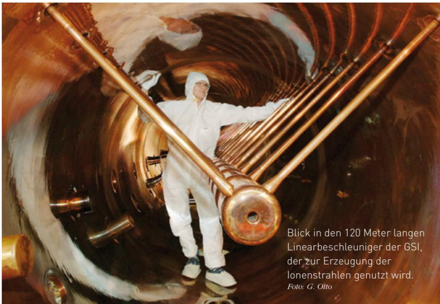
Blick in den 120 Meter langen Linearbeschleuniger der GSI, der zur Erzeugung der Ionenstrahlen genutzt wird.
