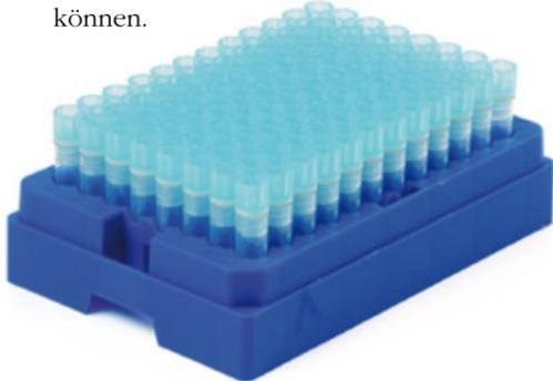
Alle pre-capped Tubes der Firma Micronic werden zur Gewährleistung von Sterilität und Reinheit gemäß dem US-bundesstaatlichen Standard 209E Klasse 7 für den Einsatz in Reinräumen hergestellt. Pre-capped Tubes bieten viel beschäftigten Labors außerdem eine bequeme und kosteneffektive Möglichkeit, den mit dem Verschließen von Probenröhrchen zugebrachten Zeitaufwand zu minimieren.
