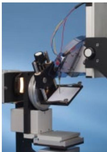
Ausgangs- und Endpunkt der Neigebewegung festgelegt und mit der Messung koordiniert. Der Tropfen kann auf die ebene oder auf die geneigte Probe dosiert werden.
