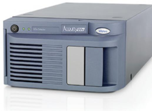
Der ACQUITY QDa Detektor ist perfekt auf die Chromatographie abgestimmt und dahingehend optimiert, Ihre Proben zu verarbeiten, ohne probenspezifische Einstellungen seitens des Anwenders zu benötigen – wie es eigentlich in der traditionellen Massenspektrometrie nötig wäre. Zum allerersten Mal kann nun jeder Mitarbeiter in einem Analytiklabor qualitativ hochwertige Massenspektren aufnehmen. Routinemäßig und ohne spezielles Vorwissen oder Training.
