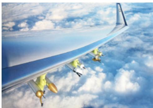
HALO fliegt mit einer der modernsten Wolken-Instrumentierungen weltweit. In den sogenannten „Unterflügelstationen“ sind unter anderem PMS-Sonden – Messinstrumente für Wolkentropfen und Eiskristalle – eingebaut.
