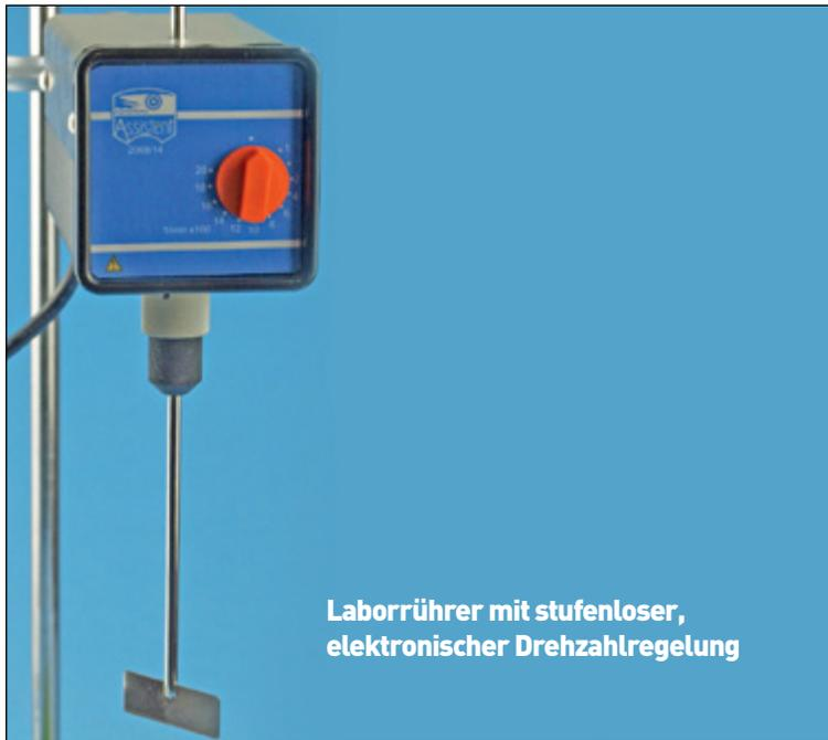
Laborrührer mit stufenloser, elektronischer Drehzahlregelung
