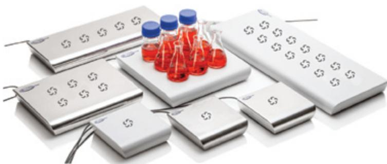
SHP Steriltechnik AG hat mit großem Erfolg seine neuen Magnetrührer LAB-OMAG auf der analytica vorgestellt. Es stehen Magnetrührer mit einer Rührstelle bis zu 14 Rührstellen zur Verfügung. Alle Rührer verfügen über einen leistungsstarken, verschleißfreien Induktionsantrieb der ohne bewegliche Teile arbeitet. Die Geräte im Industrie- und im Pharmastandard sind bis 60°C tauchbar.
