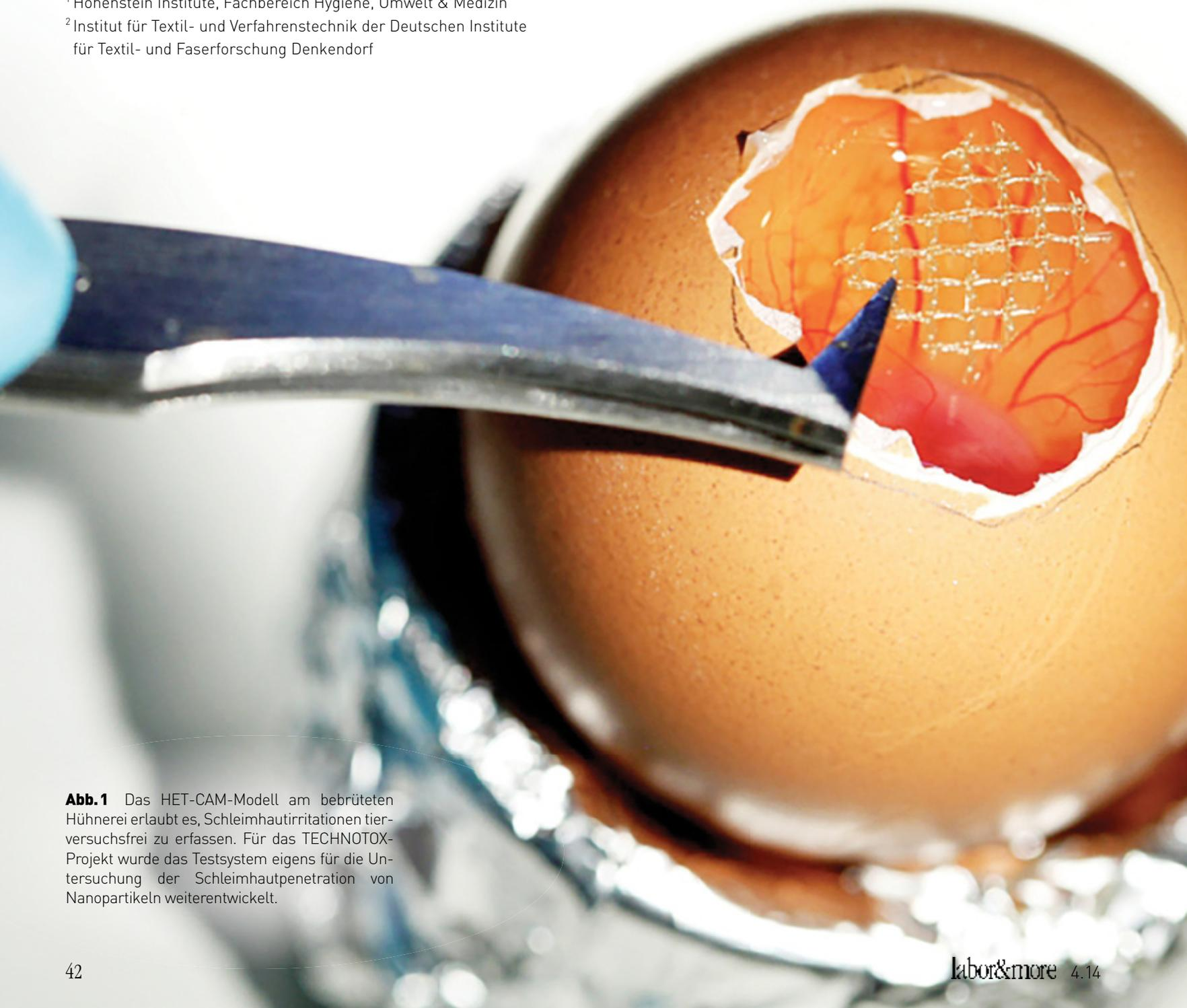
**Abb. 1** Das HET-CAM-Modell am bebrüteten Hühnerei erlaubt es, Schleimhautirritationen tierversuchsfrei zu erfassen. Für das TECHNOTOX-Projekt wurde das Testsystem eigens für die Untersuchung der Schleimhautpenetration von Nanopartikeln weiterentwickelt.
