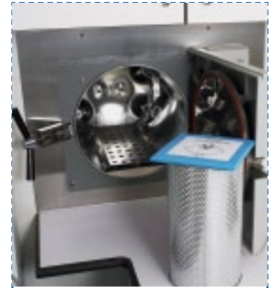
Autoklavierbare HEPA-Filterpatronen sind wirtschaftlich, umweltschonend und nur bei Sicherheitswerkbänken mit 3-Filter-System von Berner International serienmäßig.
