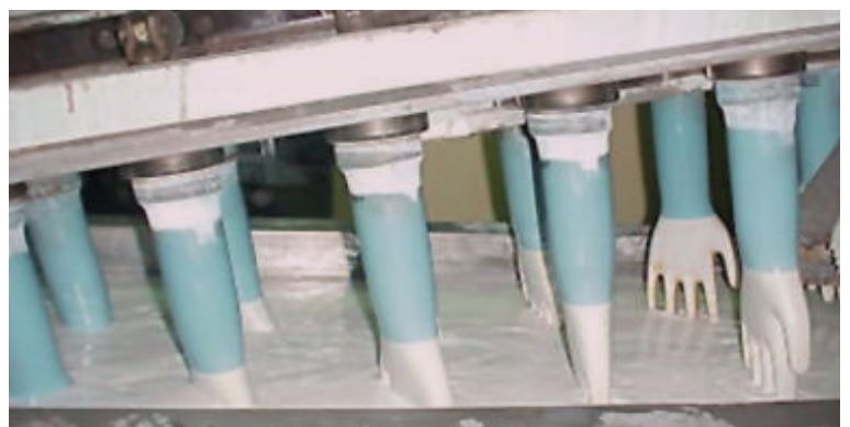
Die Produktion von Latex-Schutzhandschuhen umfasst viele Schritte. Hier sehen Sie den eigentlichen Tauchvorgang, bei dem das flüssige Latex auf die Form kommt.
