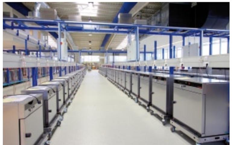
Blick ins neue Memmert-Prüfzentrum für die Endprüfung der Geräte
