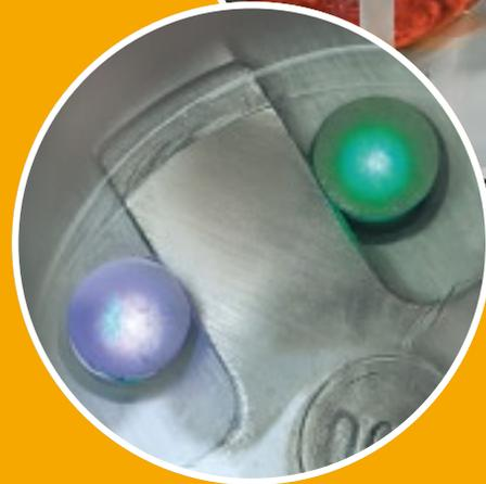
SENSOLUX® ist ein mit einem optischen Sensorsystem ausgestattetes Schütteltablar zur Messung von pH-Werten und der Konzentration von gelöstem Sauerstoff während der Kultivierung tierischer Zellen.
