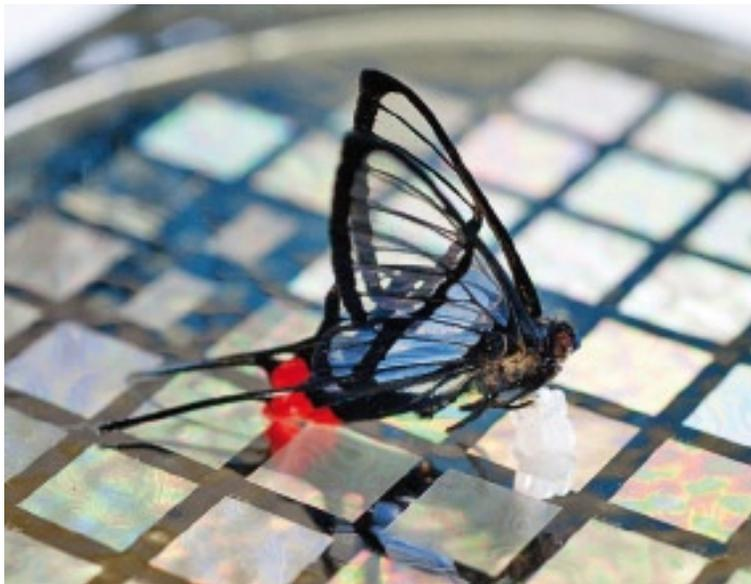
**Der flächige Sensor soll bereits die Berührung eines 20 mg leichten Schmetterlings erkennen.**
